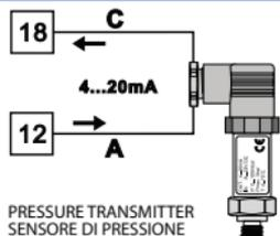
Per segnali normalizzati in corrente 0/4...20mA con sensore a due fili
