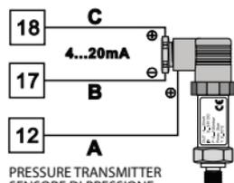
Per segnali normalizzati in corrente 0/4...20mA con sensore a tre fili
