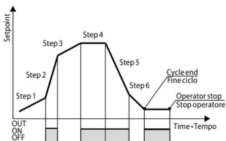
Lo stato di ON o OFF dell'uscita ausiliaria è selezionabile per ogni segmento (step) di ogni ciclo. Lo stato è impostabile anche a fine ciclo.
