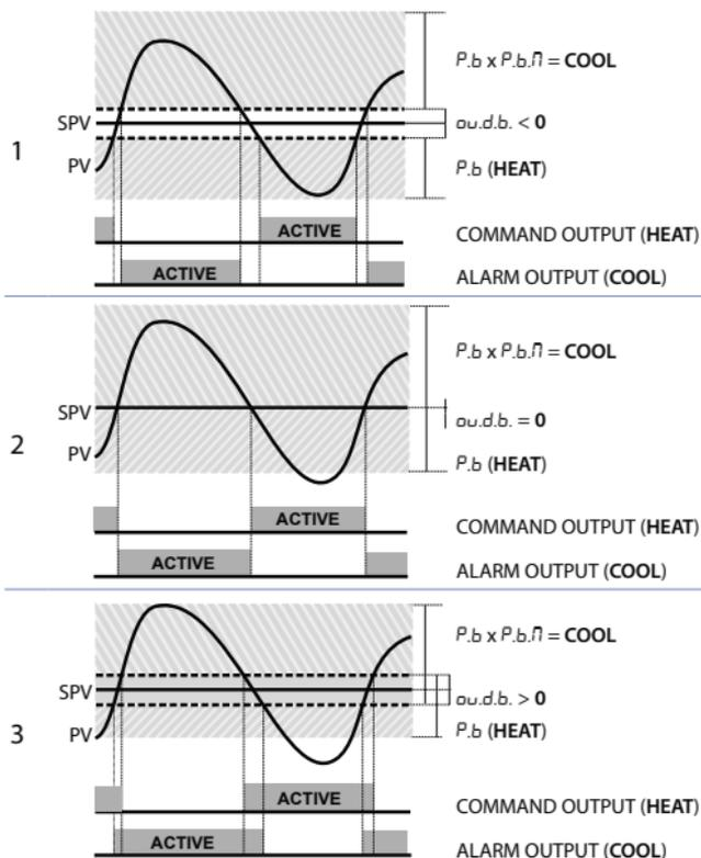
Il parametro  $co.c.t.$  ha lo stesso significato del tempo di ciclo per l'azione caldo  $\epsilon.c.$ . Il parametro  $coo.F.$  (Cooling Fluid) pre-seleziona il moltiplicatore di banda proporzionale  $P.b.\eta$  ed il tempo di ciclo  $co.c.t.$  del PID freddo in base al tipo di fluido refrigerante:
